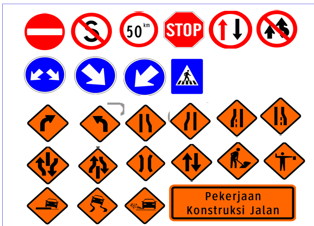
Gambar 10.7 Rambu Lalu Lintas pada Tahap Konstruksi
