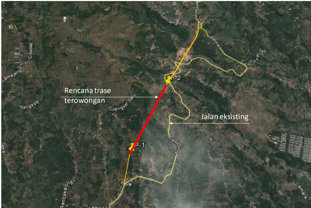
Gambar B.2 - Rute alternatif konstruksi terowongan jalan atau galian lereng tinggi topografi pegunungan
