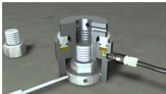
Gambar 30. Ilustrasi pengencangan metode Hydraulic Bolt Tensioners
