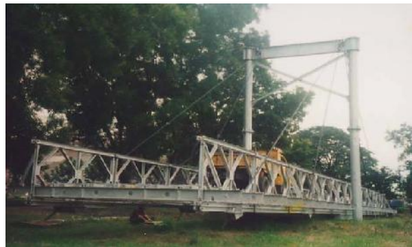
Gambar A. 3 - Pengujian beban-getar prototipe jembatan Bailey modifikasi kabel (1997)
