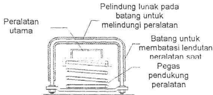
Gambar 4 Alat bantalan pegas dengan penahan lendutan lateral
