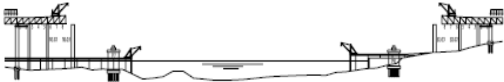
Gambar 20. Tahap 1 : pemasangan bentang tepi pada pilar-pilar sementara
