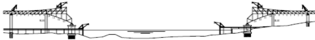
Gambar 21. 2T ahap 2 : pilar sementara dibongkar setelah bentang tepi terpasang
