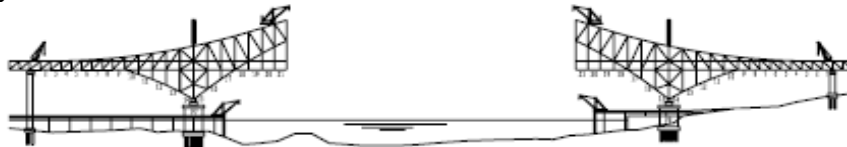
Gambar 22. Tahap 3 : semua pilar sementara dibongkar dan pemasangan bentang utama pelengkung ke pertemuan panel tengah
