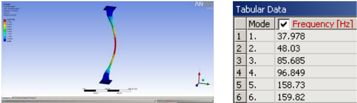
Gambar D.7 Simulasi mode getaran hanger FEM dengan frekuensi teoritis
