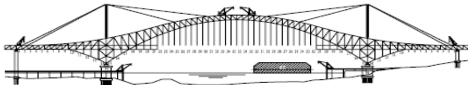
Gambar 23. Tahap 4 : kabel pengangkat untuk penyesuaian kedudukan struktur di segmen penutup
