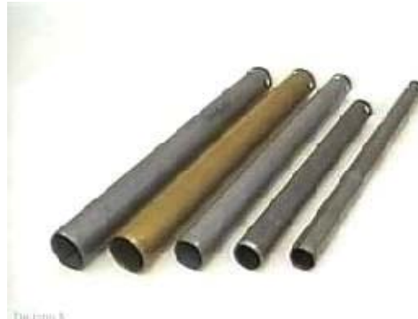
Gambar 15 Tipe dan ukuran terpilih tabung dinding tipis Shelby
