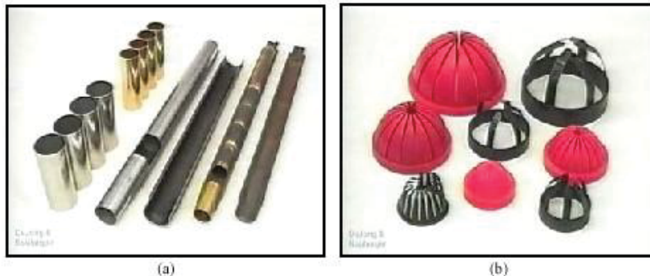
Gambar 13 Tabung laras belah: (a) cincin alat penahan dari nirbaja dan kuningan; (b) alat pengambil bola contoh (FHWA NHI-01-031)
