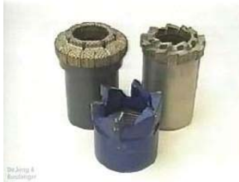
Gambar 23 Matabor inti dari kiri ke kanan: intan, karbit, dan gerigi (sawtooth)
