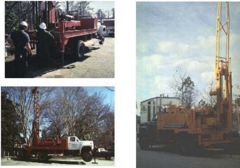
Gambar 29 Pemandangan perlengkapan alat bor putar diangkut di atas truk untuk penyelidikan tanah dan batuan
