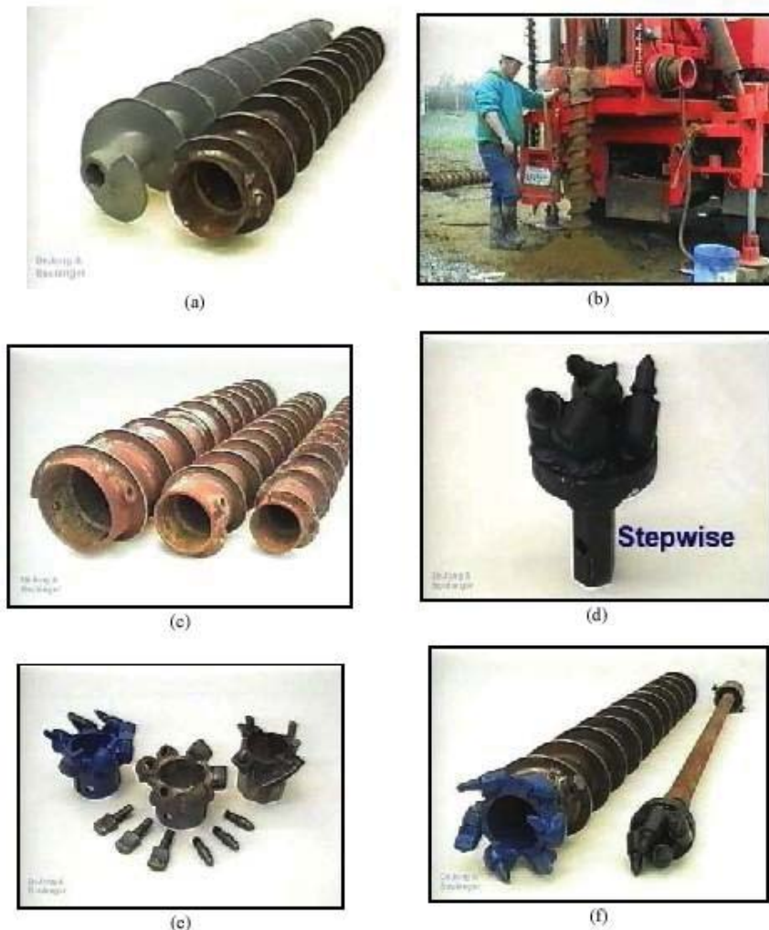
Gambar 7 Sistem bor auger tangga putar batang berlubang ( hollow ) menerus: (a) perbandingan dengan bor auger batang; (b) konfigurasi bor auger batang berlubang tipikal; (c) ukuran bor auger batang berlubang; (d) matabor bentuk tangga terpasang di tengah; (e) matabor luar; (f) matabor bagian luar dan tengah ( FHWA NHI-01-031 )
