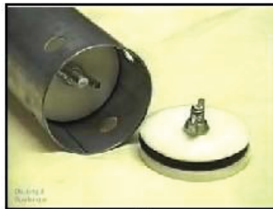
Gambar 16 Metode penutupan tabung Shelby : (a) lilin/parafin mikrokrystalin, (b) cincin packer
