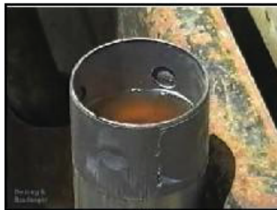
Gambar 16 Metode penutupan tabung Shelby : (a) lilin/parafin mikrokrystalin, (b) cincin packer
