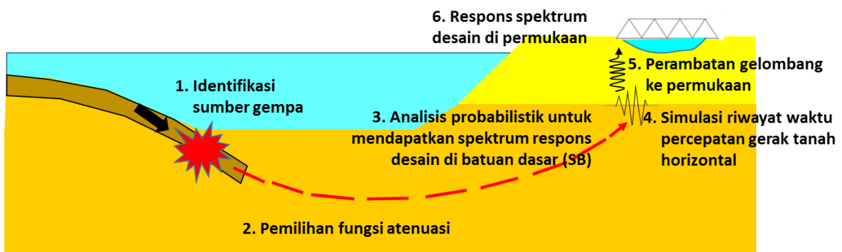
Gambar 9 - Tahapan analisis spesifik-situs menggunakan pendekatan probabilistik (Irsyam. M, et al, 2007)
