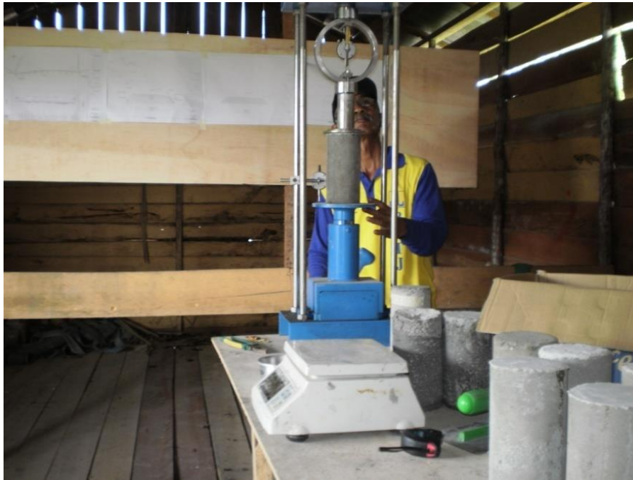
Gambar A.27 - Pengujian kuat tekan bebas (UCS) di Laboratorium (Pusjatan. 2009)
