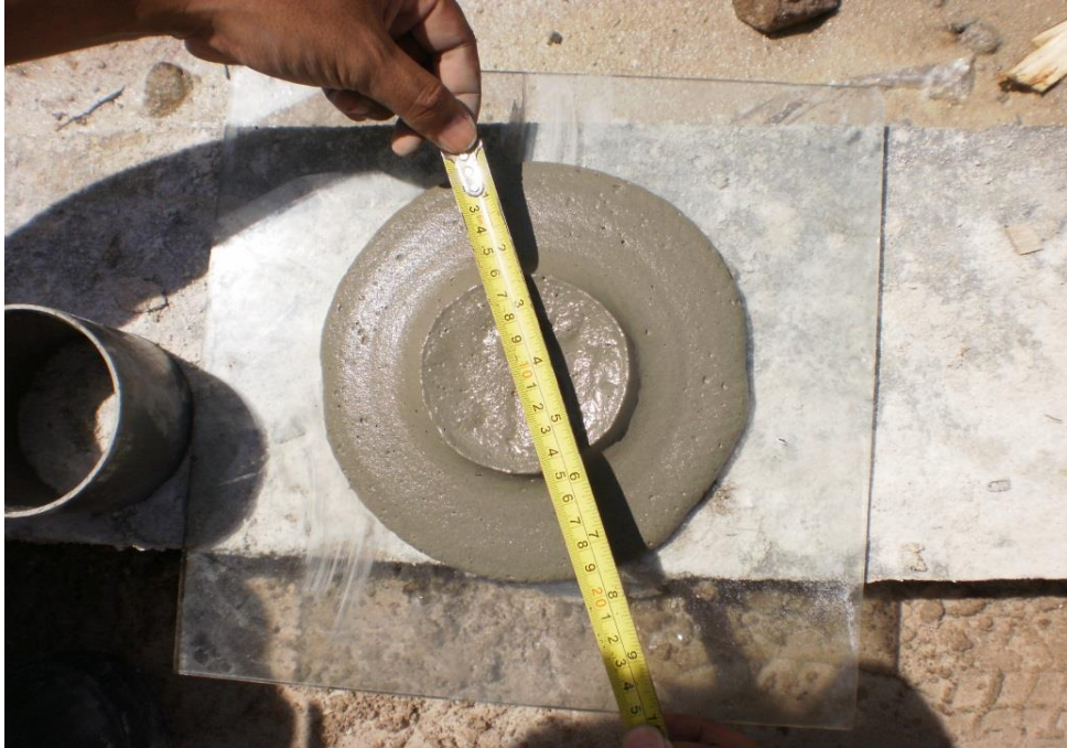
Gambar A.16 - Pengecekan flow (Sumber : Pusjatan. 2009)
