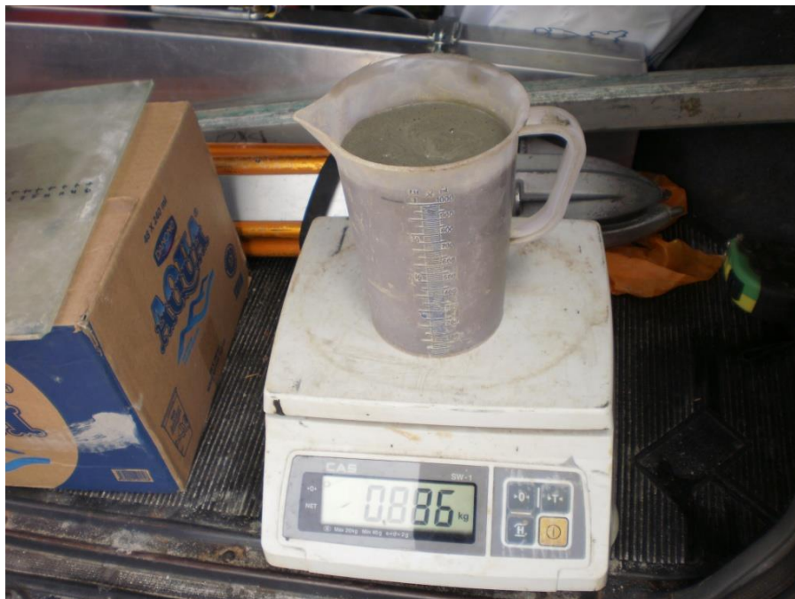
Gambar A.17 - Pengecekan densitas basah (Sumber : Pusjatan.pu.go.id, 2012)
