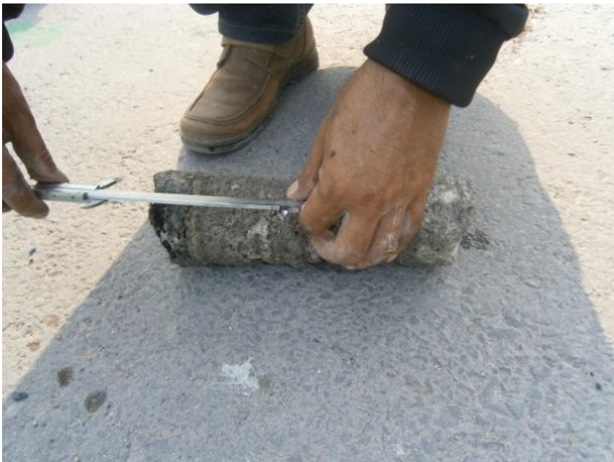
Gambar A.30 - Hasil core drill (Pusjatan. 2009)
