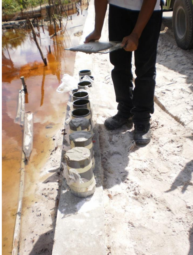
Gambar A.23 - Pembuatan silinder (Sumber : Pusjatan. 2009)
