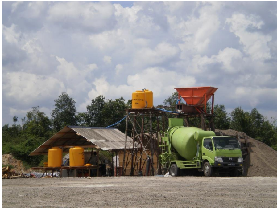
Gambar A.8 - Satu sistem pembuatan material ringan mortar-busa (Sumber : Pusjatan 1 . 2009)
