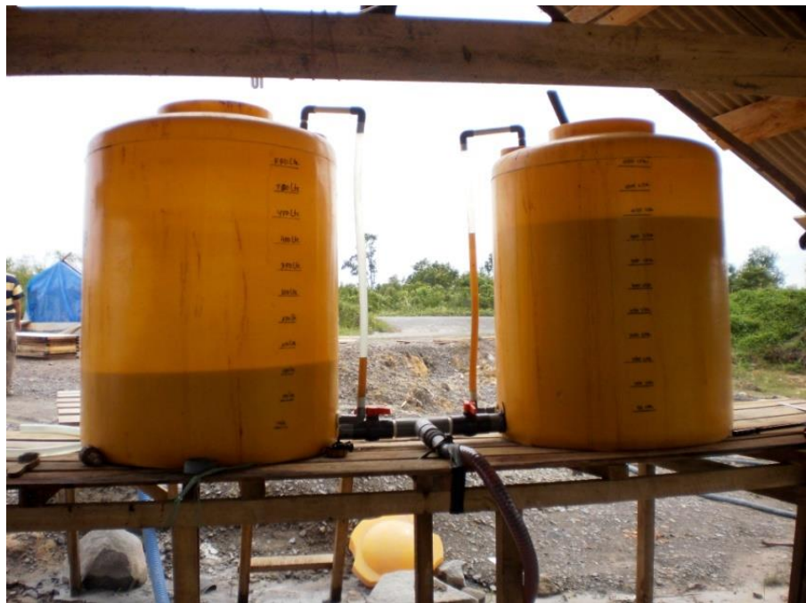
Gambar A.1 - Bahan baku busa dalam tangki (kiri) dan air dalam tangki (kanan) (Sumber : Pusjatan. 2009)
