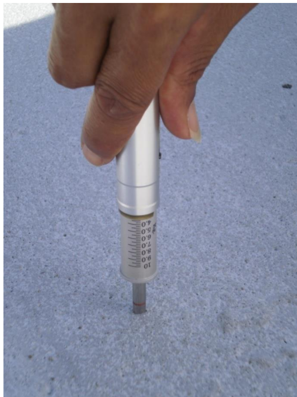
Gambar A.26 - Pengecekan setting time sebelum pembukaan bekisting (Pusjatan. 2009)
