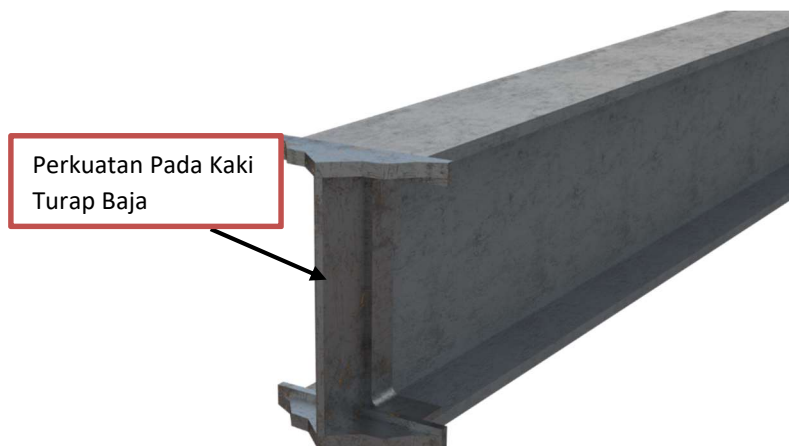
Gambar 8.4– Sketsa pemasangan perkuatan pada kaki turap baja
