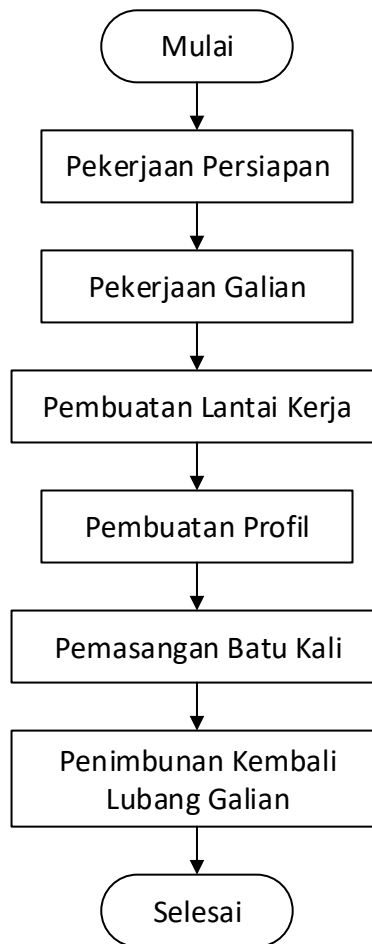
Gambar 4.1 - Diagram alir metode pelaksanaan fondasi pasangan batu
