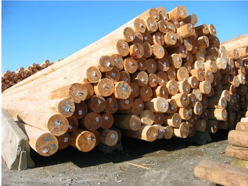
Gambar 4.13 - Tiang pancang kayu
