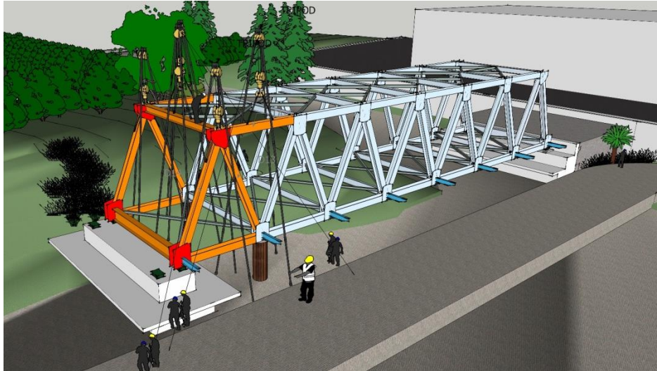
Gambar 6.69 - Perakitan Rangka Baja
