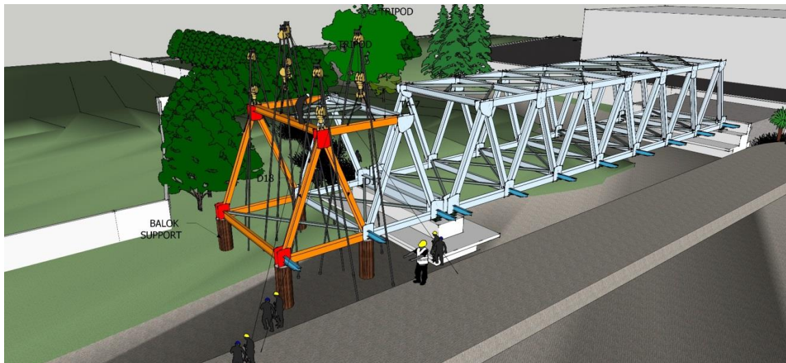
Gambar 6.75 - Pengulangan perakitan Rangka Baja panel kedua span berikutnya
