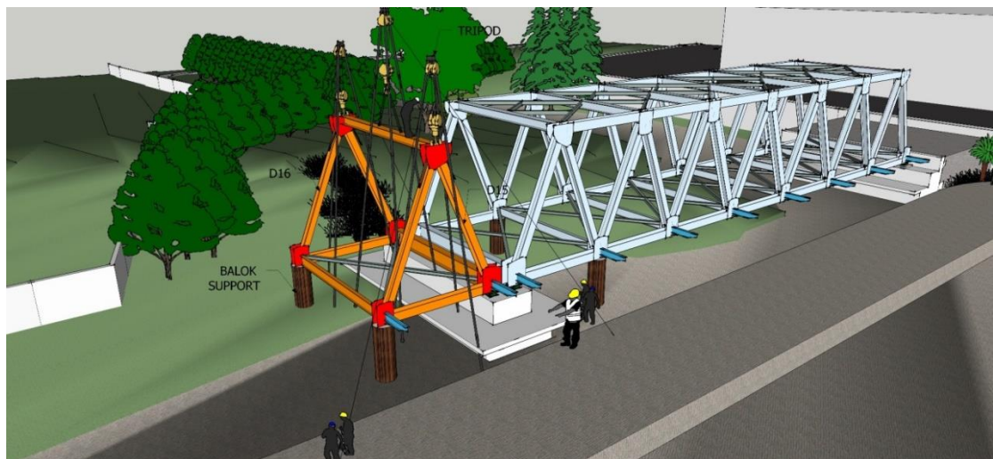
Gambar 6.74 - Pengulangan perakitan Rangka Baja panel kesatu span berikutnya
