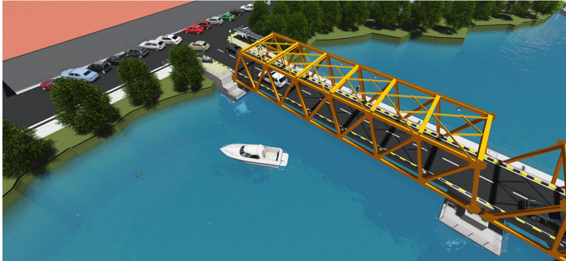
Gambar 6.78 - Konstruksi jembatan rangka baja
