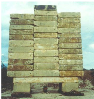
Gambar 4.38 - Uji pembebanan statis dengan metode beban mati ( kentledge )
