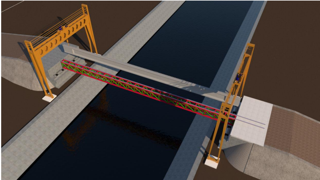
Gambar 6.50- Proses Erection dengan Portal
