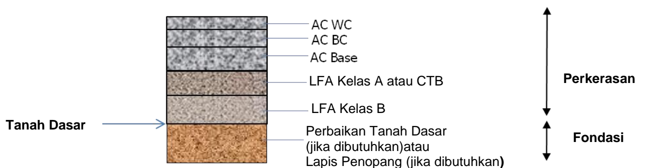
Gambar 1.1. Tipikal Struktur Perkerasan Lentur (Lalu Lintas Berat).
